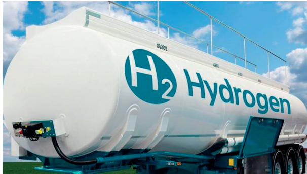
Figura 4. Dipòsit per transportar hidrogen liquid
